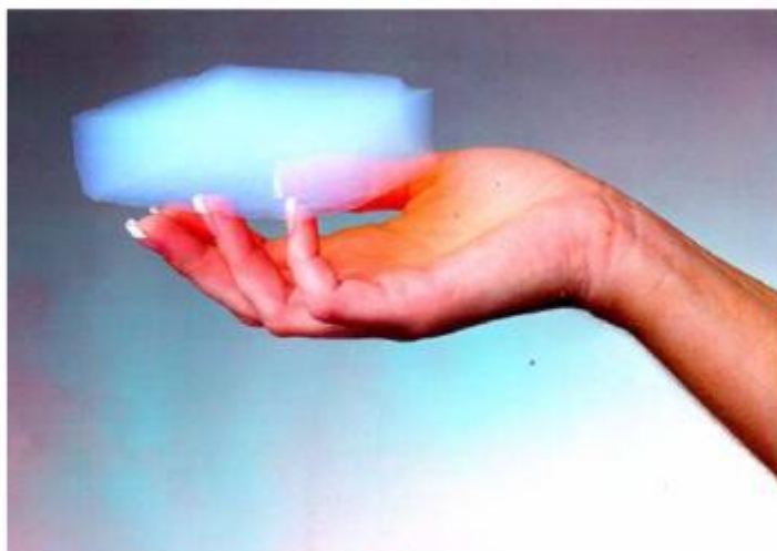
Aero-gel hecho virtualmente de aire (hasta 99,5%). Fuente: NASA
